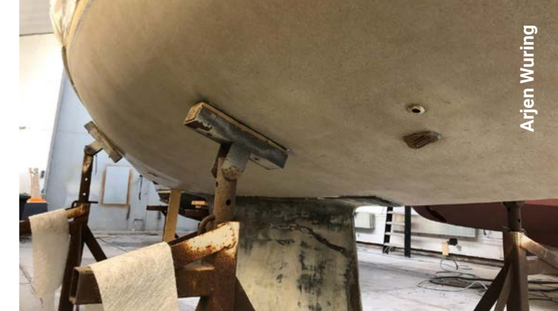
Een kaal onderwaterschip droogt beter en sneller dan wanneer er nog een verfsysteem op zit. Deze romp van een Friendship 28 is professioneel gezandstraald in verband met osmose.
