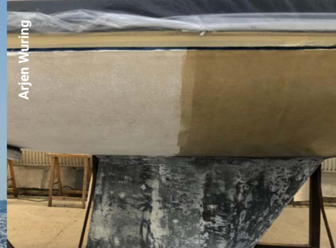
Arjen Wuring Is de kale boot droog, dan kun je er een epoxysysteem of andere primer op zetten.
