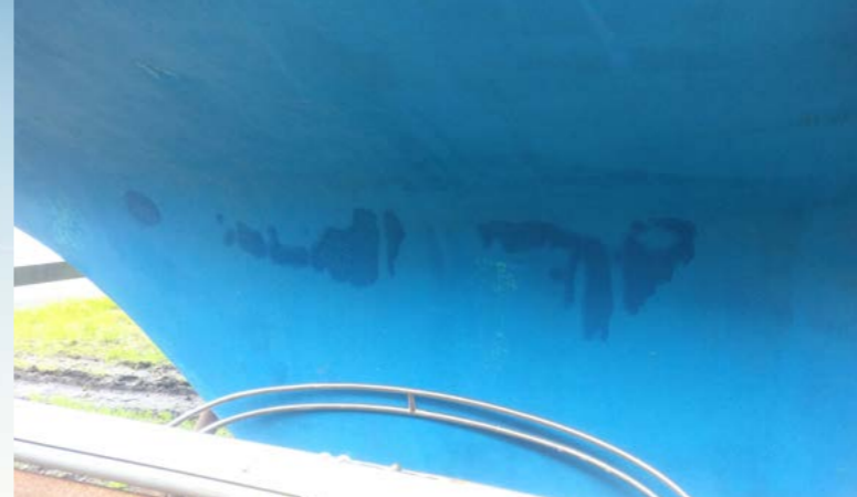
Condens bij het lood in de kiel kan erger lijken dan het is. Een meting geeft uitsluitsel
