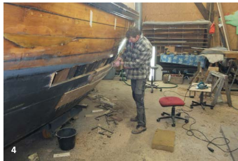
1 Marco van der Meulen is bezig met de eerste te vervangen gang. Nadat die in vorm gestoomd is en nogmaals gepast is, wordt er teer gesmeerd op de plekken waar de inhouten de gang raken • 2 De nieuwe gestoomde en geteerde gang ligt klaar • 3 Marco checkt met zijn timmermansoog of de gang goed tegen de inhouten valt • 4 Marco werkt met een driehoeksschrapper gang nummer twee bij aan stuurboord. Boven zijn handen is te zien dat sommige gangen aardig vermolmd zijn • 5 Nieuw hout in de steven aan stuurboord. Gelukkig voldeed de voorsteven nog prima • 6 Uiteindelijk bleek het toch beter vrijwel de gehele kop te vervangen aan stuurboord, dat bleek pas toen de botter in de loods aan een echt grondige analyse kan worden onderworpen
