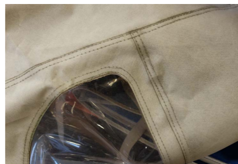
boven: Bij Zeilmakerij Molenaar wordt het lijkontouw van de fok van een aak met de hand hersteld
